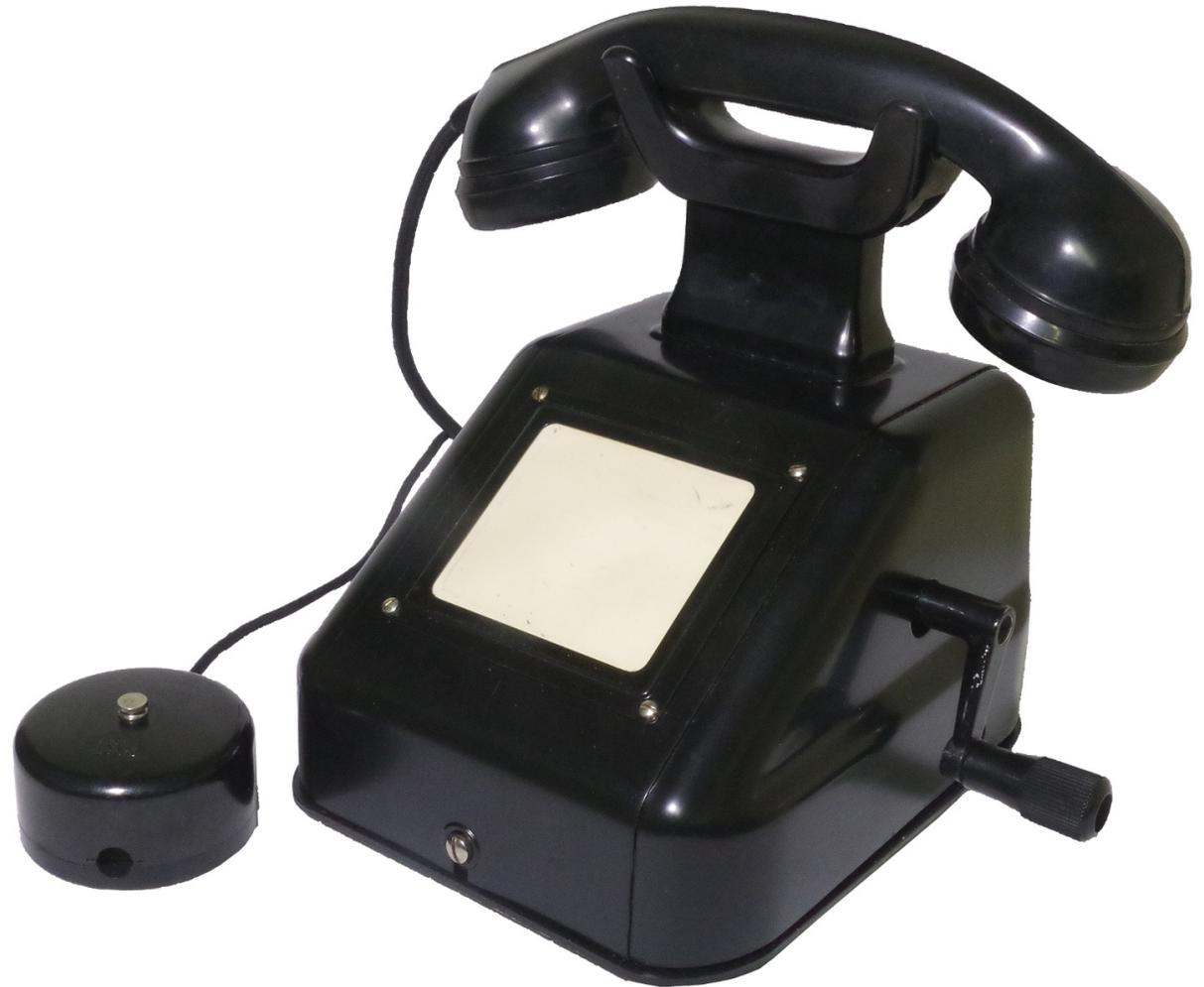
Tischapparat für Ortsbatteriebetrieb, entwickelt 1933
