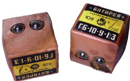
Diese beiden Batterien gehören vermutlich zu den Feldfernsprechern TA - 57. Auffällig ist die äußere Umhüllung aus einem glatten Packpapier.
