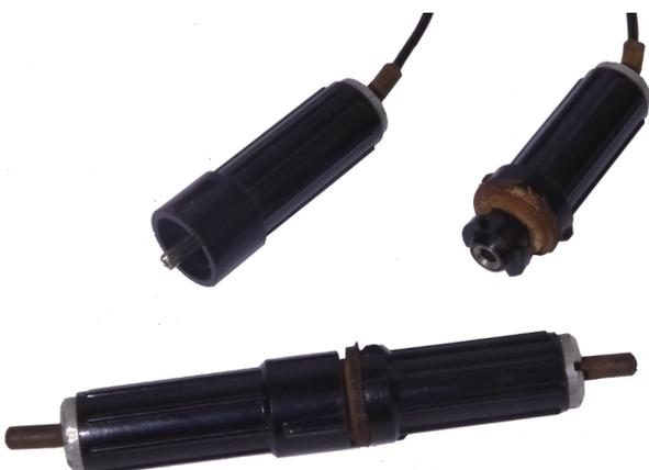
Teilweise wurden Feldkabeltrommeln mit Steckverbindern versehen. Dies erlaubte eine schnellen wasserdichte Verbindung der Feldkabel. Zudem wirkten die Stecker auch als Zugentlastung.
