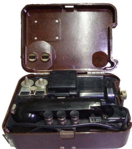
Der TA- 57 wurde in einer M- und U-Version hergestellt. Der TA-57 U hat einen zweiten Schaltkontakt in der Hörerauflage (im Bild ein TA-57 U mit den Kontakten oben links). Mit diesem konnte der Mikrofonverstärker zum Hörverstärker umgeschaltet werden. So konnte die Reichweite um 30 bis 35 % erhöht werden. In der Sammlung befindet sich ein U- und M- Gerät. Zum Betrieb verfügte das Gerät über einen 10 V Bleiakku, konnte aber auch mit einer 9 V Batterie betrieben werden.
