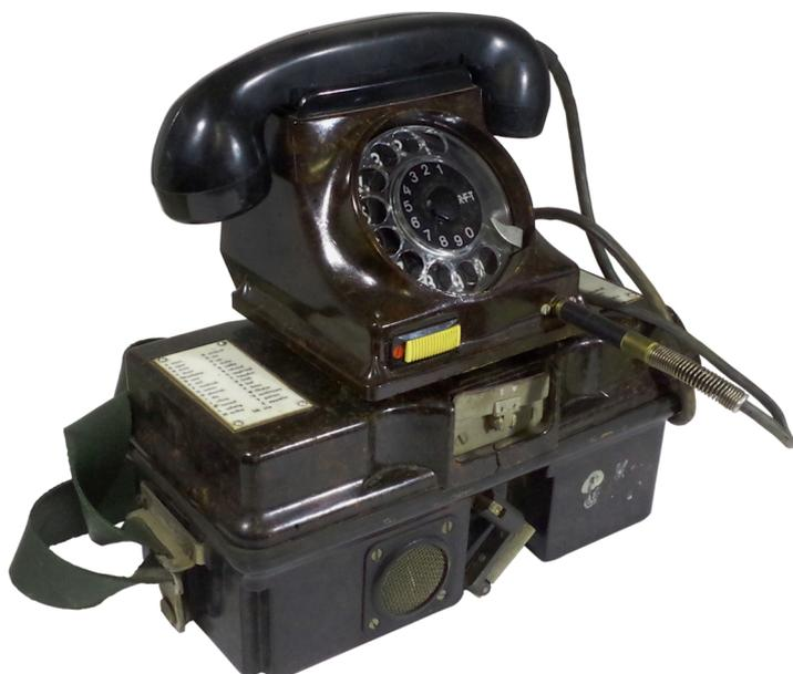
Mit dem Amtsanschießer kann der FF 63 Model S zu einem Wählapparat erweitert werden. Der Anschließer wird auf den geschlossenen FF 63 aufgesteckt. Über die Klinkenbuchse am Telefon und am Anschließer werden die Geräte verbunden, eine Verbindung mit Draht über die Anschlussklemmen ist ebenfalls möglich. Der Handapparat des Feldfernsprechers wird oben auf die Gabel des Amtsanschießers gelegt.
