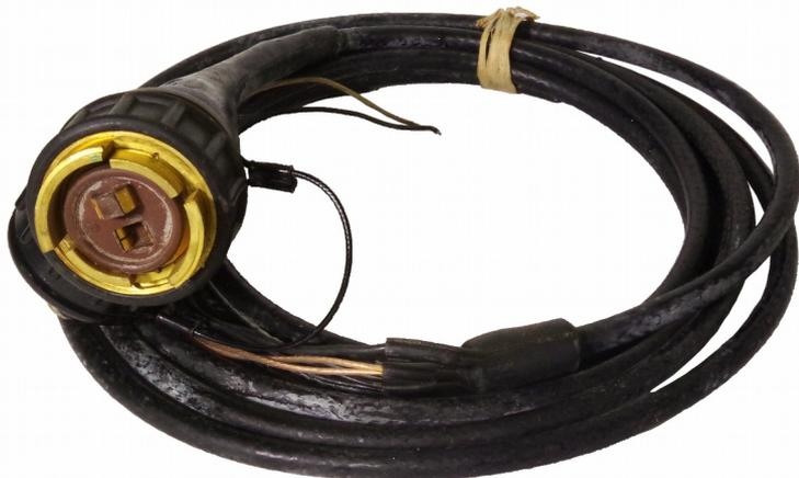
Das Feldfern-kabel befindet sich auf Trommeln zu 400 m mit einem Gewicht von 60 kg. Die Enden des Kabels sind mit einem Stecker abgeschlossen. Dieser Stecker verhindert, durch seinen Aufbau, ein Vertauschen der Adern. Konnte der Stecker nicht sofort mit einer Einrichtung verbunden werden, kam die Kabelndpeitsche zum Einsatz. Mit ihr wurden die Adern auf einzelne Drahtpaare heraus geführt.
