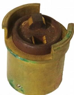
Der Prüfadapter konnte auf die Stecker des Feldfern-kabels aufgesetzt werden. An der Rückseite des Adapters wurde ein Prüfstecker eingesteckt, dieser ermöglichte den Anschluss eines Feldtelefons um ein Adernpaar zu prüfen.
