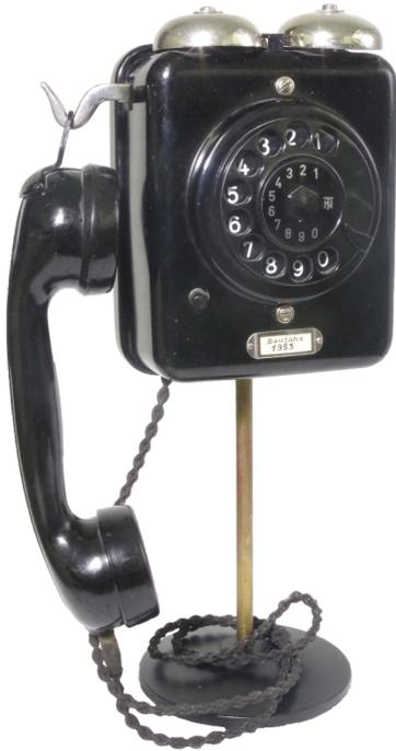
Auch der Wandapparat von 1953 hatte sein Vorbild in einem Apparat vor dem 2. Weltkrieg. Vom ZB SA19 unterschied er sich nur durch eine neue Wählscheibe und einen modernen Hörer, dessen Aufhängung nach oben gewandert war. Die sichtbaren Glocken, Form, Anordnung der Verschraubung und selbst das Beschriftungsschildchen wurden übernommen.
