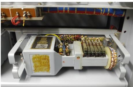
Bei der Ruf- und Signalmaschine handelt es sich um einen Elektromotor, der die Signaltöne und deren Takte erzeugt.
