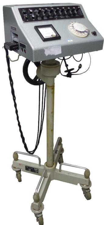
Dieses Prüfgerät befand sich auch am HVT und diente wie der Prüfschrank zum prüfen von Leitungen. Da es fahrbar war, ermöglichte es ein Arbeiten direkt am HVT, was die Suche nach Störungen und das Verfolgen von Verbindungen vereinfachte.
