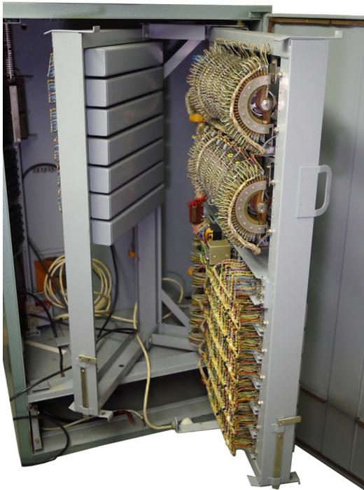
Die Wähler und Relaisgruppen sind in einem schwenkbaren Rahmen eingebaut.
