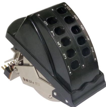
Die Wähltrommel wurde von Siemens & Halske 1950 in den Tischapparat Fgtist 264b eingebaut. Mit diesem schlanken und eleganten Telefon wich, zum ersten mal nach dem Krieg, ein Hersteller von der üblichen Telefonform ab. Die Wähltrommel wurde auch in Vermittlungen eingebaut, da sie mit nur einer Bewegungsrichtung, die Handsehen schonen sollte.
