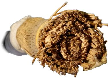
Kabel mit einer Papierisolierung wurden von den 30'iger bis in die 70'iger Jahre als Ortskabel verlegt. Sie stellten die Verbindung zwischen Kabelverweiger (KVz), dem grauen Kasten an der Straße, zum Haus her. Die Kupferadern haben einen Durchmesser von 0,6 mm und sind mit vier Adern verseilt. Zur Isolierung wurde ein Papierfaden um die Ader gewickelt. Er diente als Abstandhalter zum Papierstreifen, der danach um die
