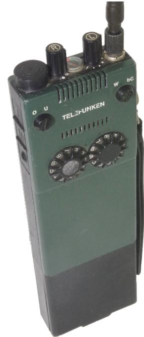
Die Schalter für die Bandlage und für die Betriebsart waren als kleine Knöpfe, mit einem Schlitz für eine Münze, ausgeführt. So sollte ein versehentliches Umschalten vermieden werden. Das FuG 10a verfügte über eine Sendeleistung von 1 W. Telefunken bot unter der Bezeichnung TELECONTACT eine Fahrzeughalterung an, die eine Bedienung und den Anschluss eines Handapparates im Fahrzeug ermöglichte. Vergleichbar mit dem Konzept der Passiv + bzw. Aktivhalterungen im TETRA- Funk.
