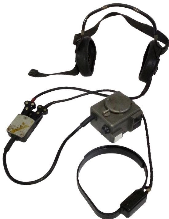
Die Lärmgarnitur LG 19S ergänzte das SE 19. Die beiden Kopfhörer sollten auch in einer lauten Umgebung für eine gute Verständigung sorgen. Die Tastung des Senders erfolgte automatisch durch die Sprache des Nutzers. Um dabei Umgebungsgeräusche aus zu schließen, wurde mit einem Kehlkopfmikrofon gearbeitet.
