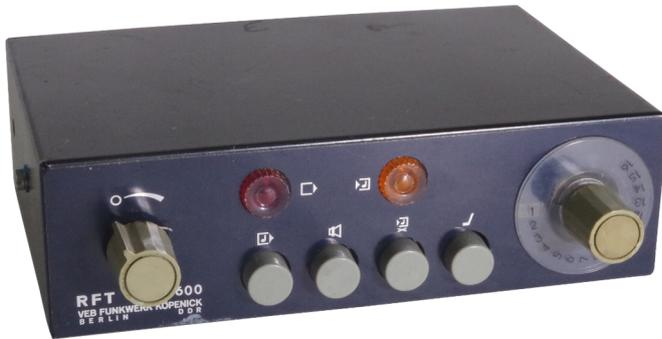
Das UBT 1.5 war als Fahrzeugbedienteil für verschiedene Funknetze gedacht: Vom einfachen offenen Netz über Netze mit Relaisbetrieb, Netze im Rufnetzbetrieb bis hin zu Selektivrufnetzen. Dabei wurden die Auftastung des Relais und die Rufaussendung automatisch bei Tastendruck ausgeführt (je nach Notwendigkeit und Vorrüstung des Gerätes). Seine Bauform erlaubte den Einbau in einen Autoradioausschnitt.
