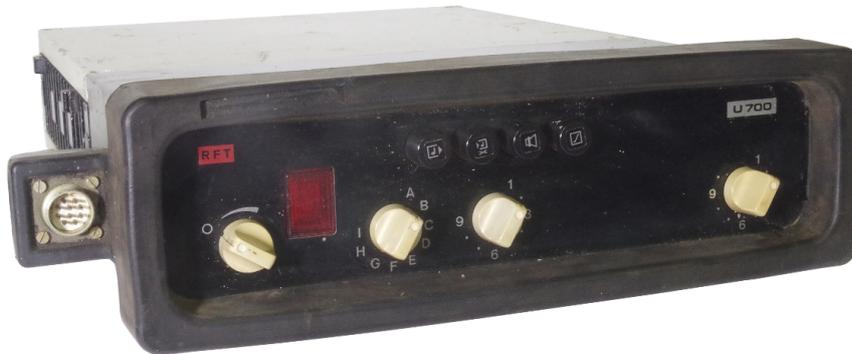
Kern des etwa 1980 eingeführten, Gerätesystems 700 bildet das Sende-Empfangsgerät. Es wurde in verschiedenen Varianten angeboten: Im 70 cm- Band mit 10 oder 100 Kanälen und 2 oder 10 W Sendeleistung. Die 2m- Version gab es mit 10, 16 oder 100 Kanälen und mit 2, 10 und 20 W Sendeleistung. Je nach Bestückung war das Gerät im Simplex-, Zweifrequenzsimplex-
