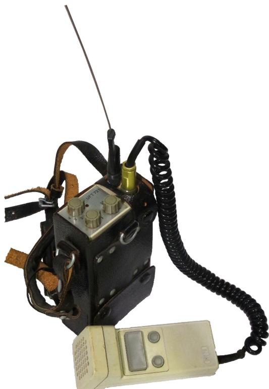
In der Regel wurde das Gerät in einer Ledertasche umgehängt betrieben. Dabei konnte das Gerät mit einer aufsteckbaren Antenne so wie einer Drahtantenne betrieben werden. Die Drahtantenne war in den Tragegurt der Ledertasche eingearbeitet.
