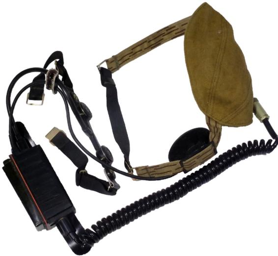
Das Sprechgeschirr war für den Einsatz bei lauten Umgebungsgeräuschen oder unter einem Helm gedacht. Es bestand aus der Kopfhaube mit Hörmuschel, zwei Kehlkopfmikrofonen und einer großen Sendetaste. Diese konnte auch leicht mit einem Handschuh bedient werden. Der Stoff der Kopfhaube hatte das bei der NVA übliche Tarnmuster, was noch einmal zeigt, dass einheitliche Geräte bei den verschiedensten Anwendern genutzt wurden.
