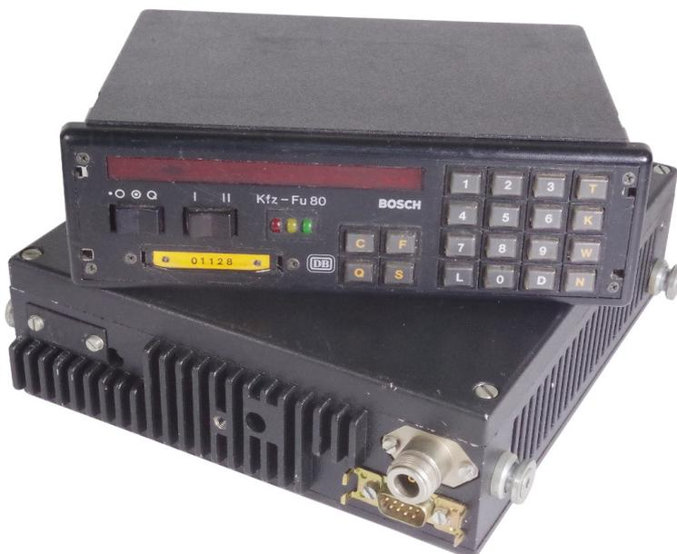
Das KF 164 war ein weit verbreitetes Betriebsfunkgerät, welches auch im 4m oder 70cm Band angeboten wurde, dann mit den Bezeichnungen KF 84 und KF 454. Das Gerät konnte bis zu 32 Kanäle haben und war Simplex und Semiduplex tauglich. Als Sendeleistungen waren 0,1, 1, 6, 12, 25 und 40 W möglich. Da das Gerät im KFZ-Funk der Bahn eingesetzt war, wird es im Semiduplex betrieben worden sein. Die Bezeichnung 20-6 steht wahrscheinlich für einen Kanalabstand von 20 kHz und eine Sendeleistung von 6 W.
