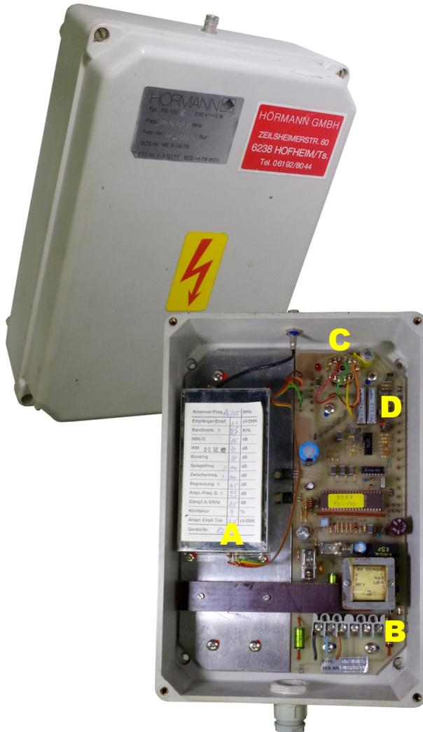
Dieser Steuerempfänger der Firma Hörmann erhielt seine Zulassung 1979. Der Empfänger (A) befindet sich links im Gehäuse, unten sieht man die Stromversorgung (B). Die Auswerteelektronik befindet sich oben auf der Platine. Die Kodierung wird durch Anlöten von Drahtbrücken eingestellt (C). Gut zu erkennen sind auch 2 Quarze zur Frequenzerzeugung für die Auswertung der empfangenen Töne (D).
