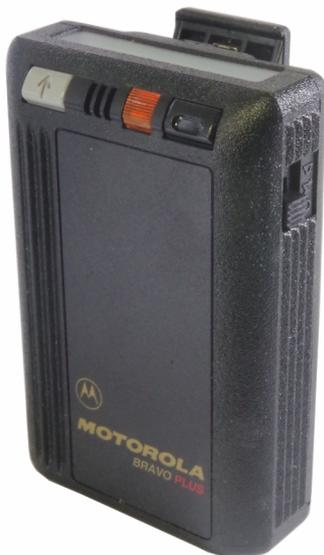
Dieser 1995 hergestellte Bravo Plus, hatte eine Numerische Anzeige. Diese zeigte die, vom Anrufer, eingegeben Ziffern bei der Auslösung an. Der Melder arbeitete mit dem POCSAC- Verfahren. Im Gerät befindet sich eine normale AA-Batterie. Für Nutzer, die auch analoge Melder kannten, war die lange Laufzeit von mehreren Tagen, mit einer Batterie, sehr überraschend.
