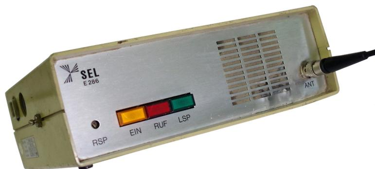
1967 erhielt die Firma Sonnenburg für den Meldeempfänger MS 200 eine FTZ- Zulassung. Dieses Gerät wurde weiter entwickelt und auch von anderen Herstellern ins eigene Lieferprogramm übernommen. So wurde das Gerät auch als AEG Telefunken MS 200-A 4/5, Storno MS 200 A 4/5, Siemens S200 und SEL E286 vertrieben. SEL erhielt, für den E286, 1975 die BOS- Zulassung.
