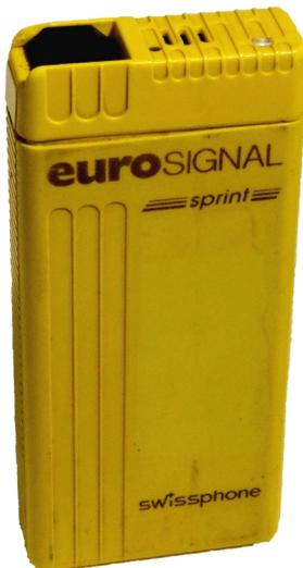
Der RE 286 wurde von Swissphone von 1990 bis 1998 gebaut. Seine Ähnlichkeit mit den Meldeempfängern der BOS von Swissphone und AEG/Telefunken ist unverkennbar. Der RE 286 war jedoch nur für die Nutzung einer Nummer ausgelegt. Der Nutzer musste, von Hand, das Gerät auf die Frequenz der Region ( Nord/Süd und Mitte) umschalten.
