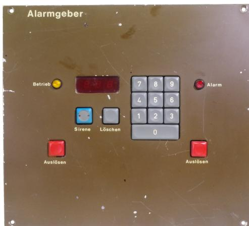
Bei diesem Alarmgeber ist keine Herstellerbezeichnung zu erkennen. Der Aufbau deutet jedoch auf einen Alarmgeber der Firma Telefunken hin. Auf der Platinenseite sind die beiden festgelegten Töne (1 und 2) gut zu erkennen: Sie werden durch eingelötete Brücken festgelegt.
