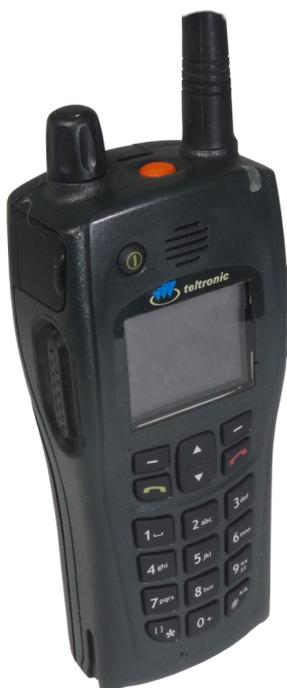
Das HTT-500 stammt auch aus der Testphase der TETRA- Einführung an der BABZ. Das Gerät stammt von der spanischen Firma Teltronic. Sie ist ein Anbieter für Endgeräte und Infrastruktur für professionelle Anwendungen in Industrie, Gefahrenabwehr und Militär. Das Gerät kann mit bis zu 3 Watt senden, bei 3 Watt beträgt die Nutzungszeit ca. 14 Stunden. Im Gerät können 1050 Gesprächsgruppen angelegt werden und es kann mit GPS, Bluetooth und einer Ende zu Ende Verschlüsselung genutzt werden.
