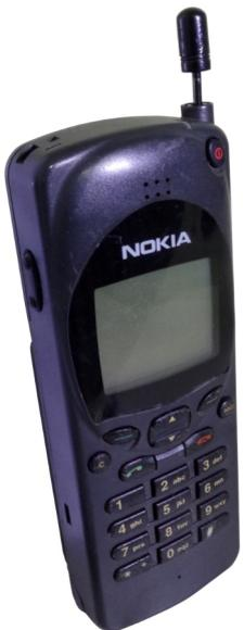
Mit der Herstellerbezeichnung NHE-1XN bringt Nokia das 2110 1994 auf den Markt. Der Einführungspreis lag bei 200 €. Mit 263 Gramm war es fast um die Hälfte leichter als das, zwei Jahre ältere, 1011. Der 600 mAh Akku sollte einen Standby-Betrieb von 30 Stunden und eine Gesprächszeit von 2,5 Stunden ermöglichen. Das monochrome Display hatte eine grüne Hintergrundbeleuchtung.
