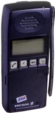
1993 bringt Ericsson das GF 197 auf den Markt. Die seitlich angebrachte Antenne kann nach oben geklappt werden und der Tastenblock ist mit einer Klappe abgedeckt. Die Taste um ein Gespräch anzunehmen befindet sich oberhalb der Klappe und die Klappe verfügt über eine Öffnung für das Mikrofon. So ist ein Gespräch auch mit einem geschlossenem Gerät möglich. Dieses erste „Klapphandy“ wird noch im selben Jahr vom, optisch fast gleichen, GF 198 abgelöst.
