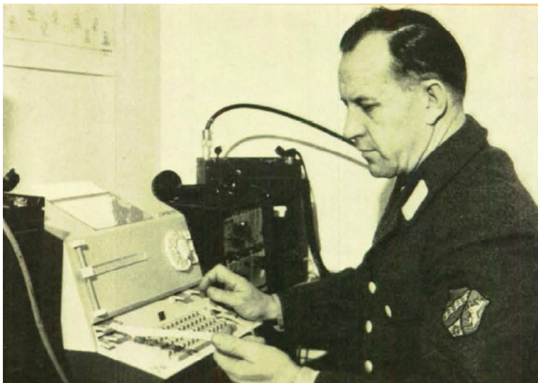
Erprobung eines vom Bundesamt für zivilen Bevölkerungsschutz zur Verfügung gestellten Funkfernsehreibers, während der Rahmenübung „Brlon“ 1971.
