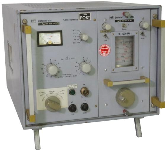
Dieser Eichgenerator mit Sendeteil wurde von der Firma Plisch 1976 für die Deutsche Bundespost hergestellt. Eichgeneratoren werden zur Überprüfung und Einstellung von Frequenzanzeigen an Empfängern verwendet. Der Generator konnte Frequenzen von 10 bis 1000 GHz erzeugen und senden.
