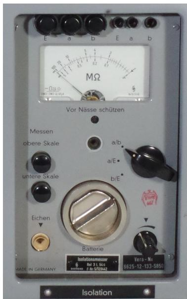
Der Isolationswiderstand wird mit einer festgelegten Gleichspannung überprüft, leider verfügen wir über keine Unterlagen die beschreiben wie die Prüfung bei diesem Gerät erfolgt. Aus einer Lehrunterlage der Landesausbildungsstätte des LSHD Wesel aus dem Jahre 1965 geht hervor, dass der Isolationswiderstand pro Kilometer größer – gleich 300 M Ohm sein sollte.
