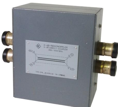
Richtkoppler werden in der Funktechnik verwendet, um einen kleineren Teil der Leistung eines Signals, für Messzwecke, auszukoppeln und einem Messgerät zu zu führen. Mit dem ausgekoppelten Signal können dann zum Beispiel Werte erfasst werden, mit denen die ordnungsgemäße Funktion einer Antennenanlage überprüft werden kann. Der Richtkoppler der Sammlung ist für Frequenzen von 380 bis 1000 MHz ausgelegt und damit ein Gerät von hoher Qualität.
