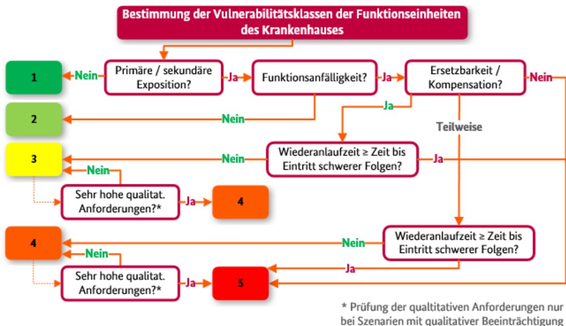
Abbildung 9: Bestimmung der Vulnerabilität der Funktionseinheiten
