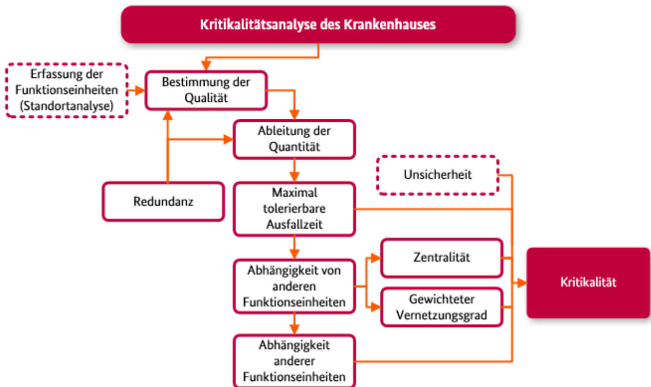
Abbildung 5: Vorgehen und zu erhebende Daten der Kritikalitätsanalyse
