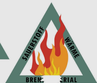
Abbildung 30 - Feuerdreieck (Brennstoff) ©EFI/WKR
