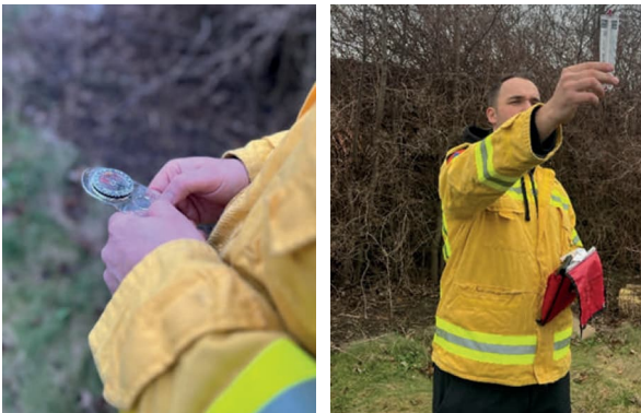
Abbildung 33 - Ermittlung von Windrichtung und -geschwindigkeit ©Waldbrandteam e.V.
